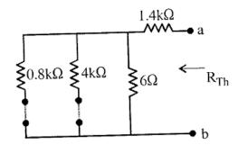
$0.8k\Omega // 4k\Omega // 6k\Omega = 0.6k\Omega$
