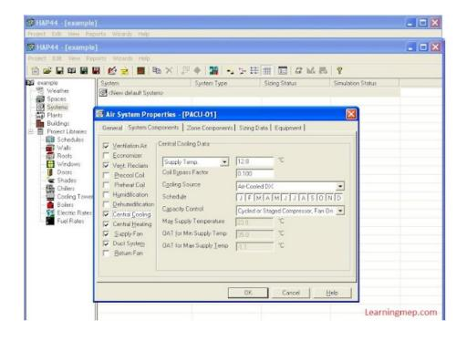
ومن القائمة Central Heating الخاصة بالتدفئة حدد درجة حرارة إرسال الهواء المفترضة كما هو بالنسبة لملف التبريد.
