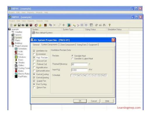
ثم من القائمة Central Cooling الخاصة بملف التبريد حدد درجة حرارة إرسال الهواء المفترضة (ولتكن °C 12.8) كما هو موضح بالشكل, والمقصود بدرجة حرارة هواء الإرسال هو درجة حرارة الهواء التصميمية الخارجة من مخارج الهواء, وأما تحديدها بدقة فيحتاج لخبرة كبيرة والرجوع لكاتالوجات وحدات التكييف لكن يمكن افتراضها ضمن حدود معينة حسب نوع وحدة التكييف.
