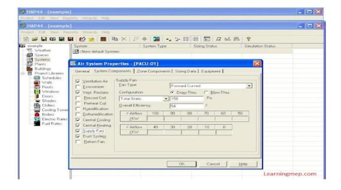
ثم من القائمة Duct System الخاصة بنظام توزيع الهواء (دكتات الهواء) حدد القيمة التقريبية للكسب الحراري للدكت كنسبة مئوية (ولتكن 2 %) والقيمِة التقريبية لتسرب الهواء من الدكت (ولتكن 3 %) وكذلك هذه النسب تحتاج لخبرة وتتأثر بنوع وجودة العزل وجودة تركيب الدكتات.
