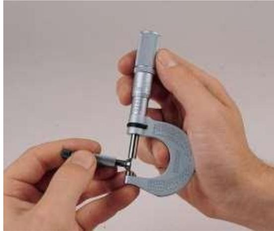
إن المايكرومتر جهاز حساس يستعمل في القياسات الدقيقة و لأغراض خاصة في المجال الصناعي, لذلك فإن على مستخدمه مراعاة بعض القواعد الأساسية التي تسمح بإجراء القياس الدقيق على الجهاز. تتم قراءة قياس المايكرومتر على النحو التالي:
