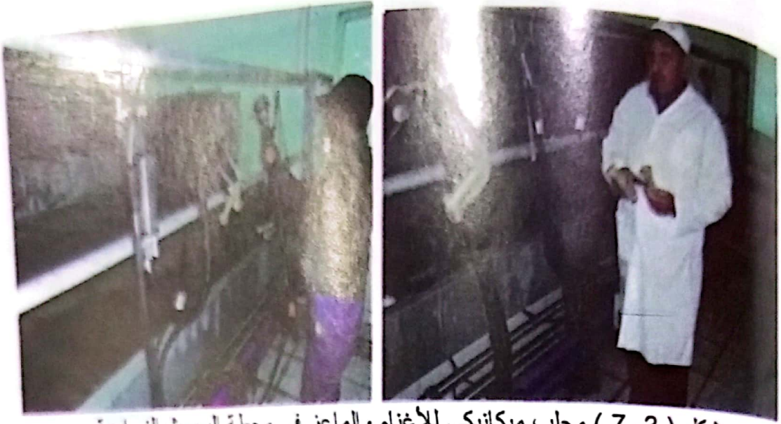
شكل ( 3-7 ) محلب ميكانيكي للأغنام والماعز في محطة البحوث الزراعية / وزارة الزراعة العراقية
