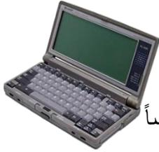
**حواسيب الكف (palmtop):** هي حواسيب صغيرة تمسك باليد، وتسمى أيضاً Note pads وهذه الحواسيب تمتلك شاشة ولوحة مفاتيح صغيرتي الحجم، وتقوم ببعض الوظائف التي يمكن أن تقوم بها حواسيب Laptops ولكن بشكل أبسط، ويمكن نقل الملفات منها إلى الحواسيب الشخصية، وأسعارها منخفضة قياساً بأنواع الحواسيب الأخرى.
