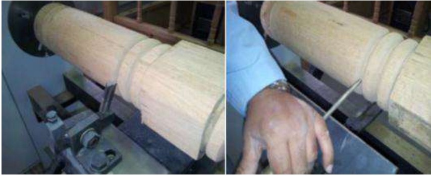
الشكل (13): عملية تشكيل الخشب باستخدام المخرطة النجارية
