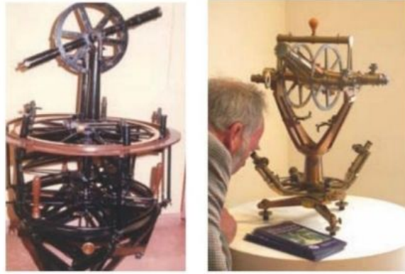
شكل (٣-١) نماذج لأجهزة ثيودوليت قديمة لقياس الزوايا
