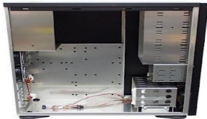
هو عبارة عن صندوق ذو أبعاد قياسية متفق عليها حتى تلائم مع أجزاء الحاسوب المراد تثبيتها أو تركيبها داخله، وظيفته هي إحتواء أهم الأجزاء الكهربائية والإلكترونية التي يتكون منها الحاسوب. والأجزاء التي يتم تركيبها داخل الصندوق هي
