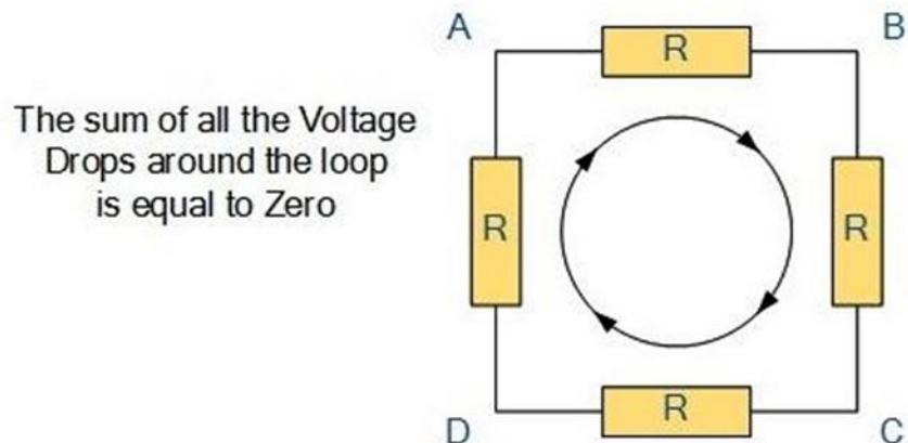
$$V_{AB} + V_{BC} + V_{CD} + V_{DA} = 0$$
